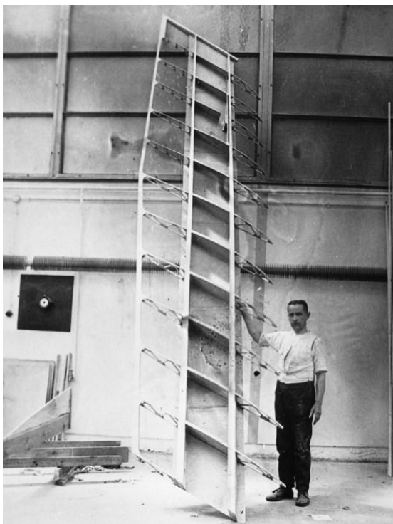
Die Soldenhoff LF 5 im Bau: Zwei Ansichten des noch weitgehend unbeplankten Flügels, die einen guten Einblick in die Konstruktion des Tragwerks erlauben.
